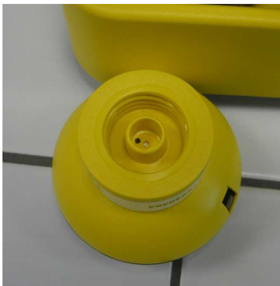
Obr. 3 Pohled zespu na snímací hlavici a v ní zabudovanou membránu citlivou na tlak (Šváb, 2016).
