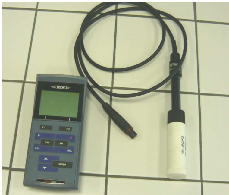
Obr. 4 Měřicí přístroj Multi 3320 a senzor Cellox ® 325 v kalibrační nádobě OxiCal ® SL (Šváb, 2016)
