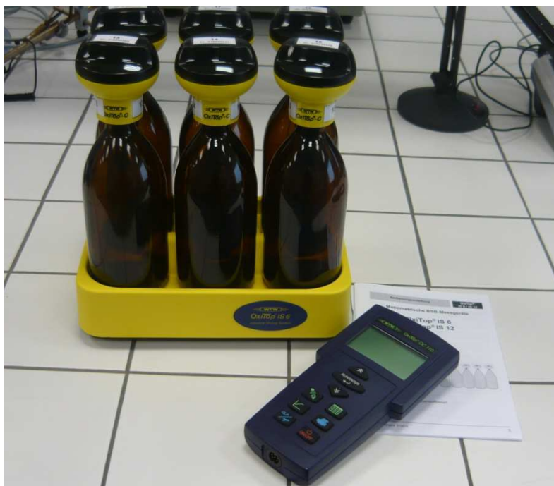
Obr. 2 OxiTop® sada 6 lahví s měřicím přístrojem (Šváb, 2016)
