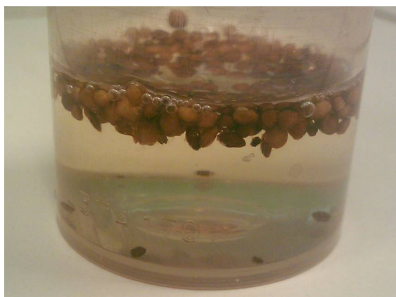
Příloha 11: Vzorek vymražených mikroperel 24 hodin namočený ve vodě.
