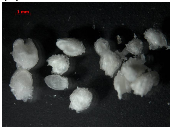
Příloha 5: Vymražené částice mikroperel 2% CH+5% TPP.
