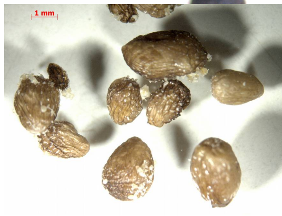
Obr. 17-20 Částice mikroperel 2%CH+5%TPP+1%HK. Shora: mokré, vysušené na vzduchu a vysušené vymražením.
