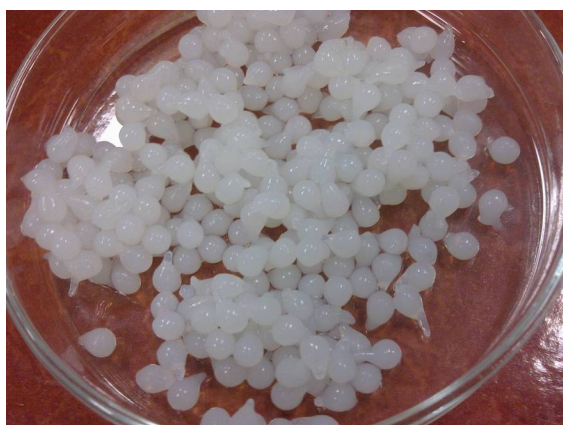
Příloha 9: Částice makroperel 3% CH v 0,5 M NaOH.
