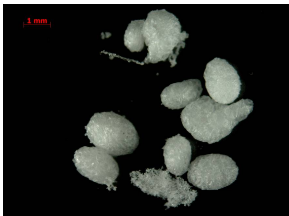
Příloha 7: Vymražené částice mikroperel 1% CH+1% TPP
