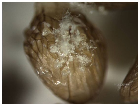
Příloha 4: Vymražené částice mikroperel 2% CH+5% TPP+0,5% HK s patrným vykrytalizováním TPP.
