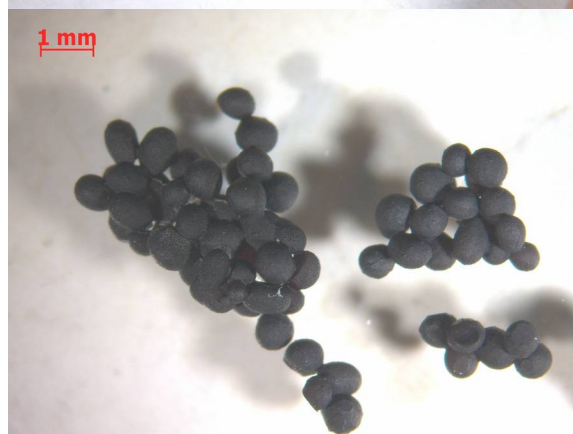
Obr. 17-20 Částice mikroperel 2%CH+5%TPP+1%HK. Shora: mokré, vysušené na vzduchu a vysušené vymražením.
