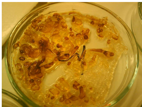
Příloha 12: Vzorek mikroperel 2% CH+2% HK vysušených na vzduchu po 24 hodinách ve vodě.
