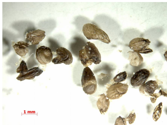
Příloha 8: Vymražené částice mikroperel 1% CH+1% HK+5% TPP
