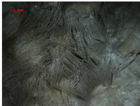
Příloha 2: Povrch částic mikroperel 2% CH+2% HK.
