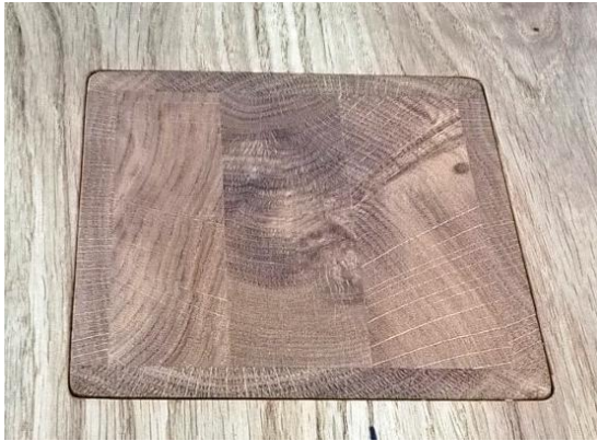
Obr. 43 Reálný pohled na nákližek
