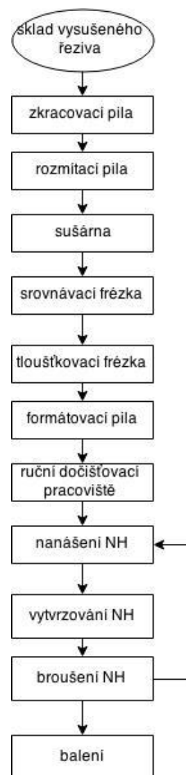
Obr. 49: II.Schéma toku materiálu při výrobě klínu
