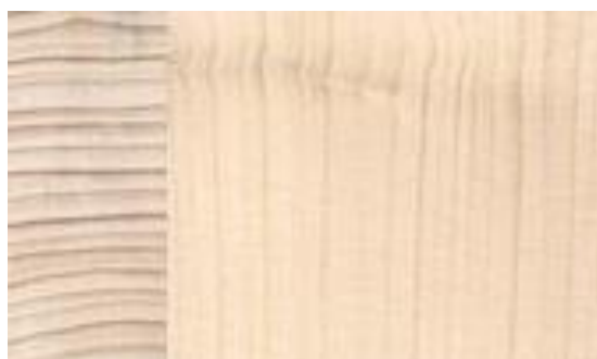
Obr. 33: Příčný a radiální řez smrkem [33]
