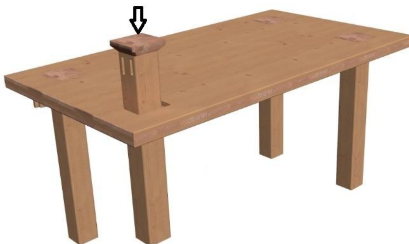
Obr. 50: Zasouvání nohy do desky při montáži
