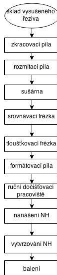
Obr. 46: Schéma toku materiálu při výrobě klínu
