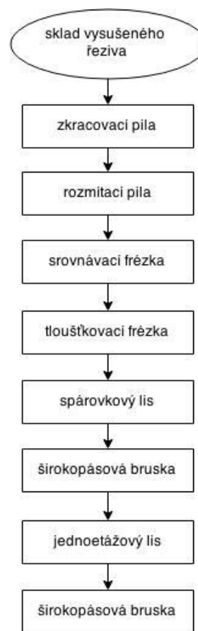
Obr. 37: schéma toku materiálu při výrobě biodesky
