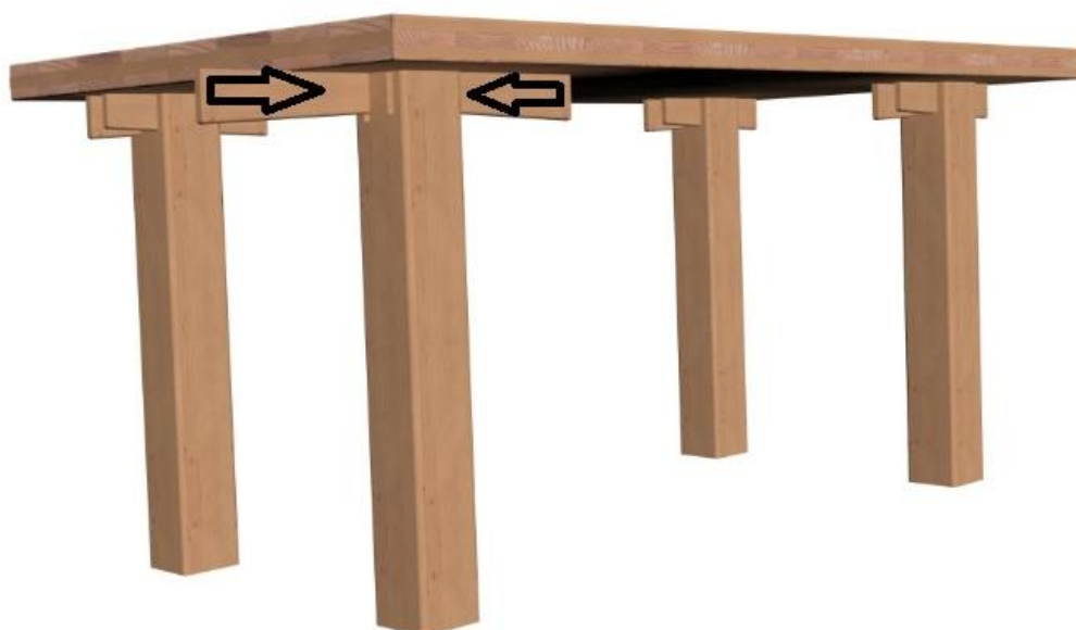
Obr. 51: Zasouvání klínů do nohy při montáži
