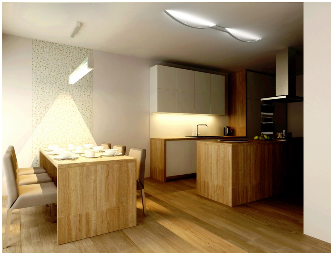
Světelné prvky v provozu, zapojeny v sérii 2ks, hliník, 2418 x 130 x 53mm, 2015
