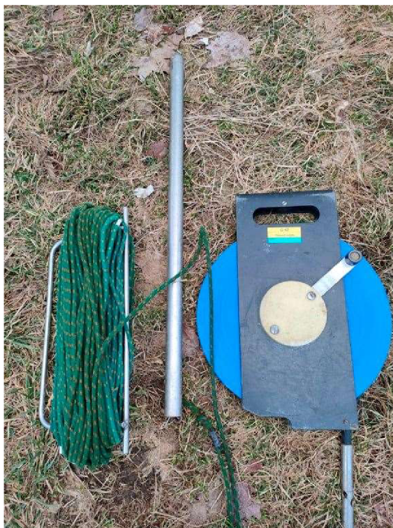
Obrázek č. 12: použité přístroje při odbírání vzorků z vrtů (Holubová, 2022).
