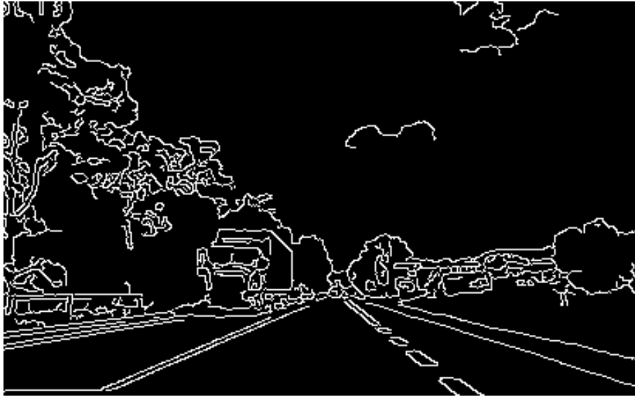
Fig. 42: Canny edge detector
