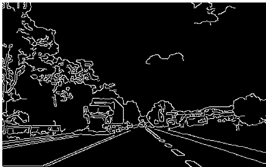
Fig. 42: Canny edge detector
