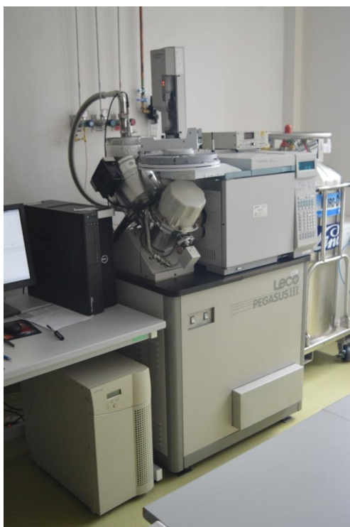
Obrázek 17: Plynových chromatograf s hmotnostním spektrometrem (LECO)
