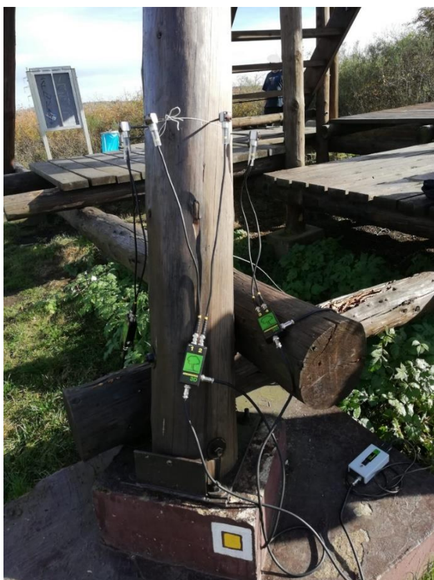
Obrázek 52: Kontrolovaný severozápadní trám (Zdroj: Autor práce)
