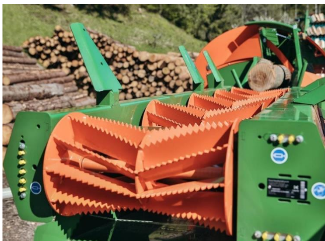
Obrázek 28 Posuvný systém pomocí ocelových válců [8]
