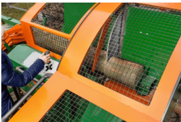
Obrázek 31 Průmyslový štípač Posch s kotoučovou pilou [8]
