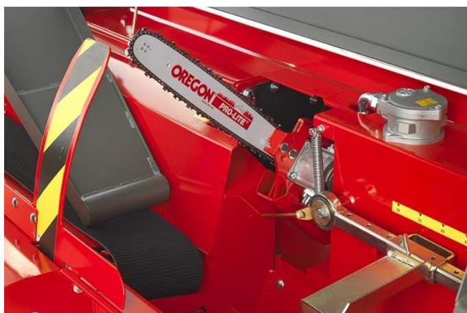
Obrázek 30 Mechanismus řetězové pily Hakki Pilke AC10 [13]
