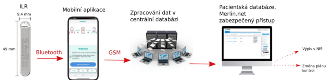
Obrázek 3.2: Loop rekordér s rozměry a schéma komunikace, včetně popisu, při využití mobilní aplikace myMerlin TM a přenos dat do patientské databáze Merlin.net schéma převzato z [2]) a kompletně vytvořeno autorem práce
