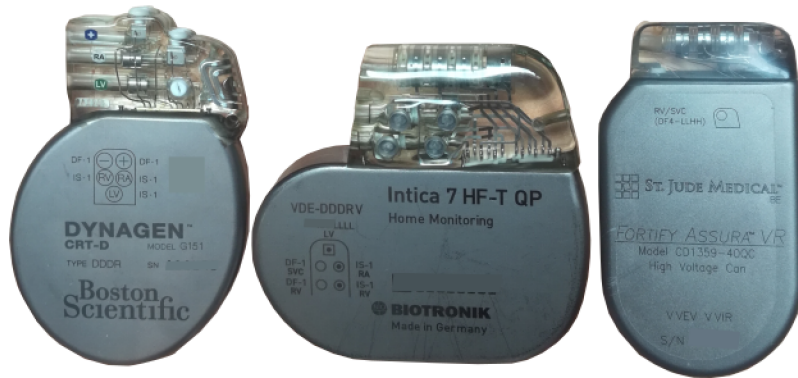
Obrázek 3.1: Různé typy a tvary implantabilních kardioverter–defibrilátorů (ICD), výrobců (zleva Boston Scientific, Biotronik a St. Jude Medical).
