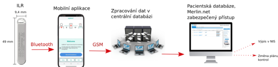
Obrázek 3.2: Loop rekordér s rozměry a schéma komunikace, včetně popisu, při využití mobilní aplikace myMerlin TM a přenos dat do patientské databáze Merlin.net
