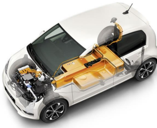
Obr. 8. Hnací soustava vozidla ŠKODA CITIGO e IV. [16]
