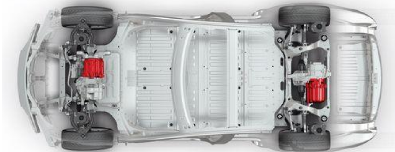
Obr. 7. Duální motor AWD (70D) pro model Tesla S. [15]
