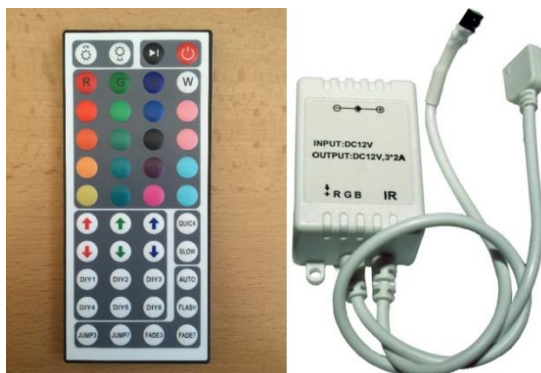
Obrázek 49 a) dálkový ovladač přísvitu b) IR čidlo dálkového ovladače
