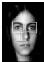
Obrázek 16 - Detekce obličeje na principu rozložení šedi
