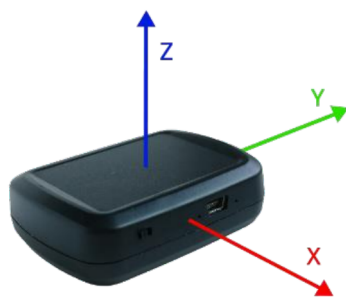
Obr. 2.2: Tag IMU, Orientace os akcelerometru, převzato z [9]
