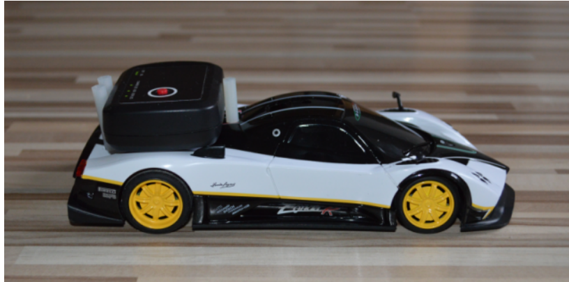
Obr. 3.13: Akvizice dat při nárazu; upravený automobil na dálkové ovládání s lokátorem
