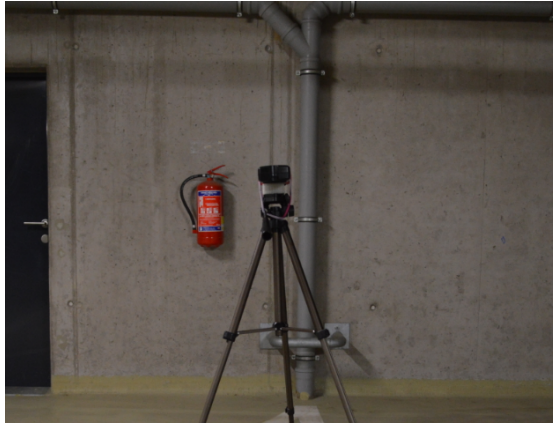
Obr. 10.5: Scénérie měření vzdálenosti, FoV s hasícím přístrojem a trubkou (vlevo); histogram naměřených hodnot při měření vzdálenosti l , l=3 m (vpravo); délka akvizice 1000 vzorků
