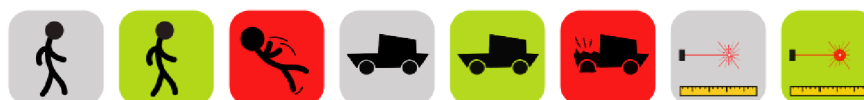
Obr. 9.6: Přehled piktogramů jednotlivých funkcí: šedá = neaktivní stav, zelená = aktivní stav, červená = detekce
