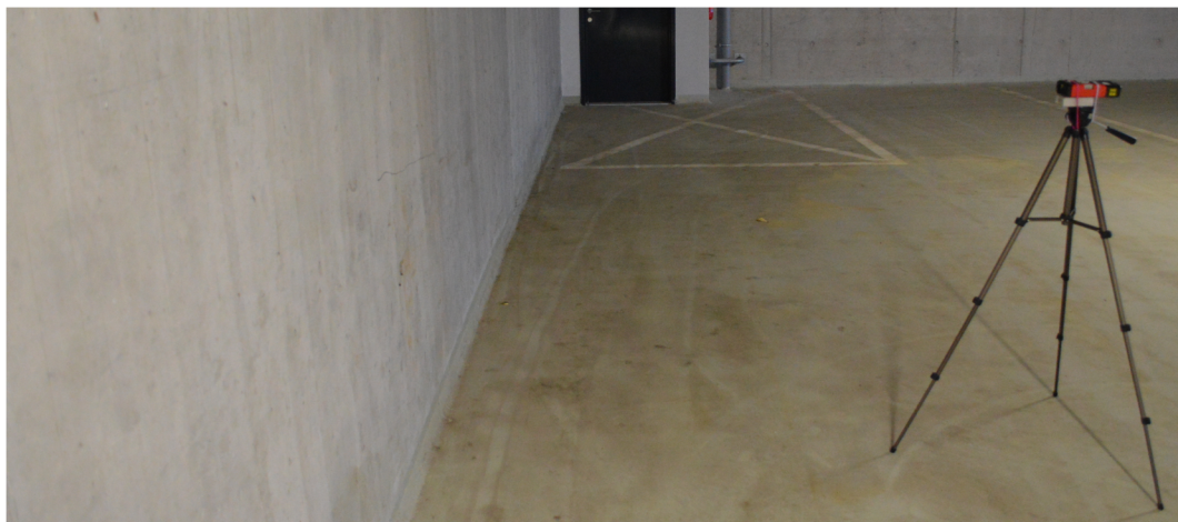
Obr. 10.1: Instalace při měření vzdálenosti 2m pomocí Tagu IMU v4r7 s implementovaným laserovým senzorem VL53L1X
