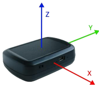
Obr. 2.2: Tag IMU, Orientace os akcelerometru, převzato z [9]
