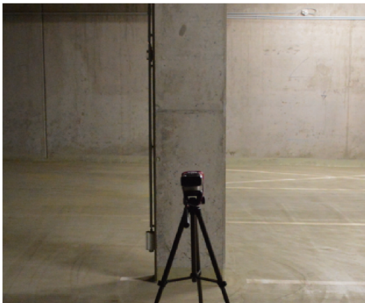
Obr. 10.6: Scénérie měření vzdálenosti, FoV se sloupem (vlevo); histogram naměřených hodnot při měření vzdálenosti l , l=3 m (vpravo); délka akvizice 1000 vzorků
