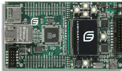
Obr. 3.3: Vývojová deska Stellaris s mikrokontrolérem LM3S8962 [17]
