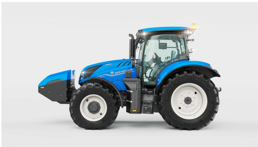
Obrázek 3.4: Traktor poháněný methanem (Agroportal24h.cz, 2021)
