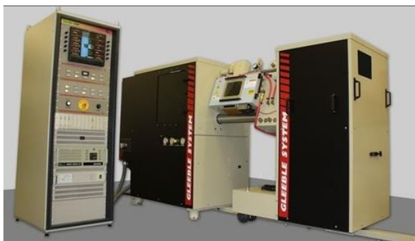
Obr. 19 Zařízení Gleeble 3500 1- ovládací panel, 2- hlavní jednotka, 3- testovací zařízení [9]
