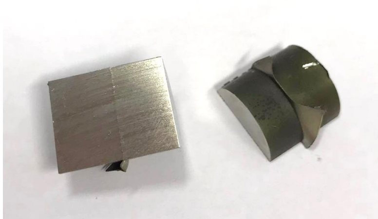
Obr. 29 Rozřezané vzorky s Ni mezivrstvou připravené na tepelné zpracování
