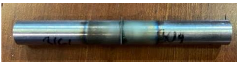
Obr. 28 Heterogenní spoj s Ni mezivrstvou
