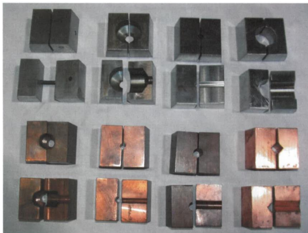
Obr. 22 Čelisti s úplným i částečným kontaktem z Cu a X5CrNi18-8 pro různé tvary vzorků [9]
