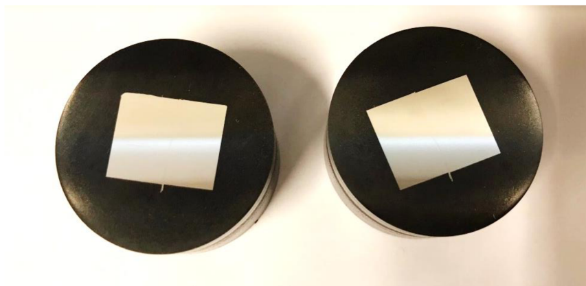
Obr. 32 Vzorky zalisované v prášku Polyfast
