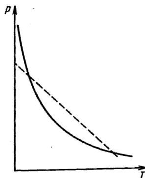
Obr. 8 Závislost mezi přitlačným tlakem a teplotou ohřevu [12]
