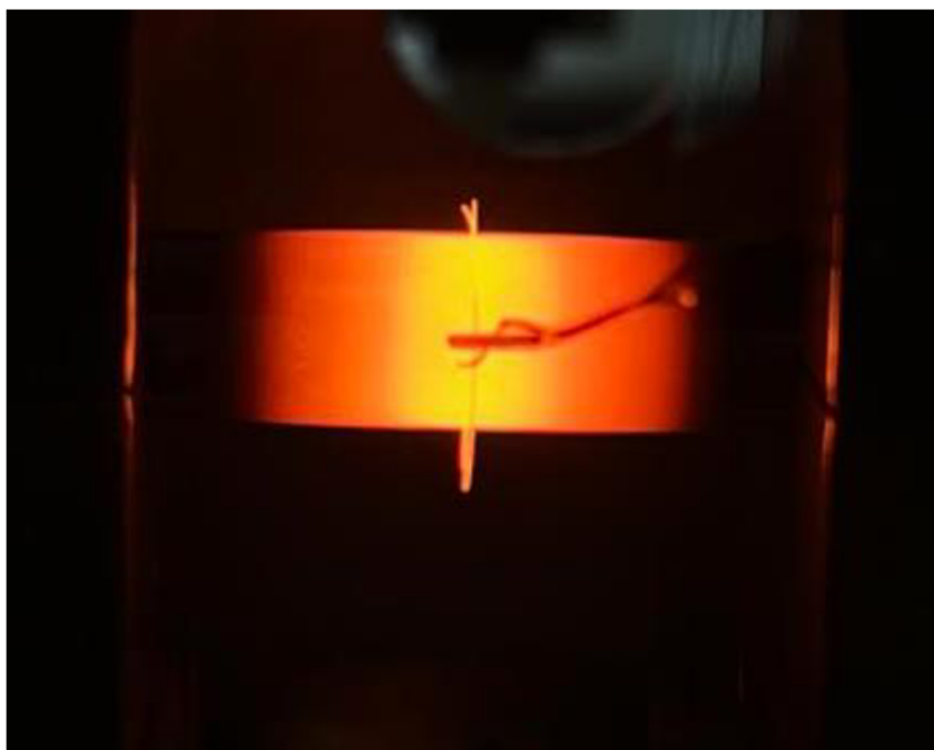
Obr. 27 Zahřátí vzorku na teplotu 1050 °C a výdrž na teplotě po dobu 15 min
