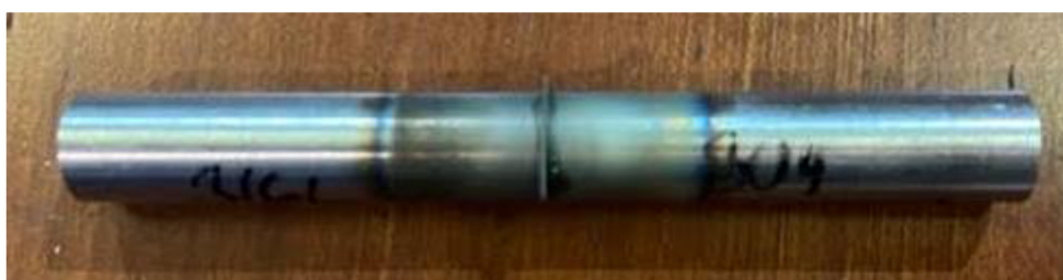
Obr. 28 Heterogenní spoj s Ni mezivrstvou
