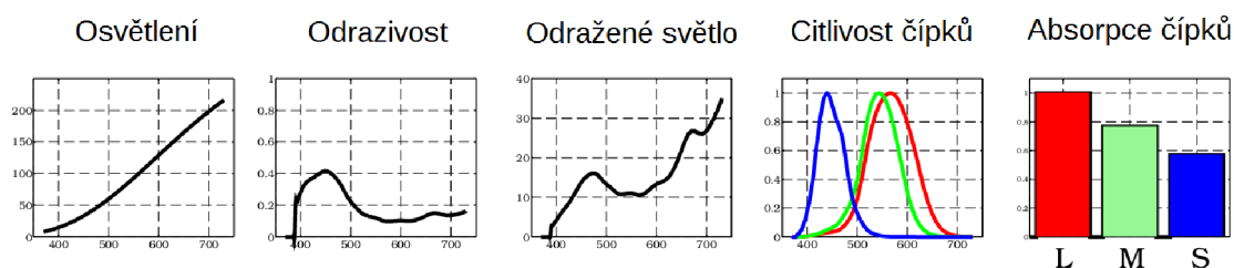
Obr. 1.3: Funkce, které znázorňují proces vnímání barvy. Na ose x je až na poslední graf vlnová délka. První graf je výkonovou spektrální charakteristikou zdroje světla, druhý je spektrem odrazivosti objektu, třetí představuje vynásobené dva předchozí. Toto odražené světlo vstupuje do oka skrze citlivost čípků (třetí graf), které světlo absorbují (čtvrtý graf, integrál křivek citlivosti). Převzato a upraveno z [4]
