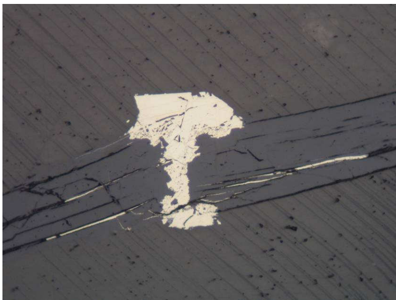
Obr. 17 Xenomorfně omezený pyrit, žilkovitě pronikající po štěpných trhlinách stilpnomelanu. Výbrus LE 18, RL.
