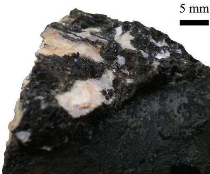
Obr. 10 Makrofotografie rozhraní stilpnomelanové rudy a hydrotermální mineralizace. Viditelná je také štěpnost karbonátu podle klence a jednotlivé šupinky stilpnomelanu. Vzorek LE 18.
