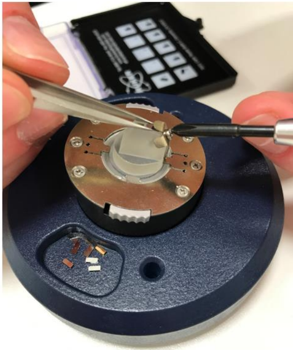
Obrázek 45 - Umístění nosníku do držáku.
