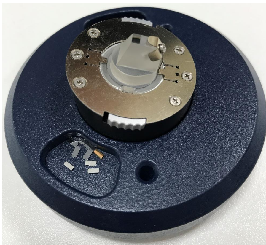
Obrázek 44 - Umístění držáku nosníku do podstavce pro výměnu.
