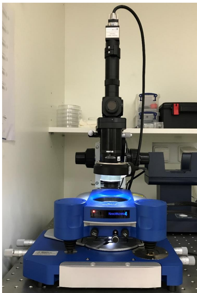
Obrázek 48 - Umístění hlavice mikroskopu atomárních sil (AFM) nad vzorek.
