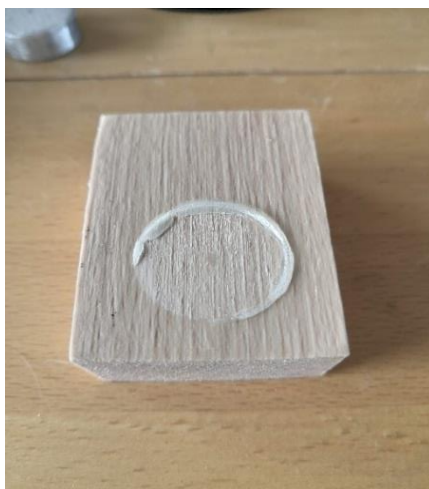
Obrázek 21 Vzorek po odtržení panenky
