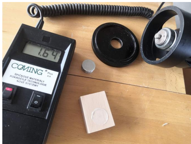
Obrázek 20 Zkouška odtrhovacím strojem
