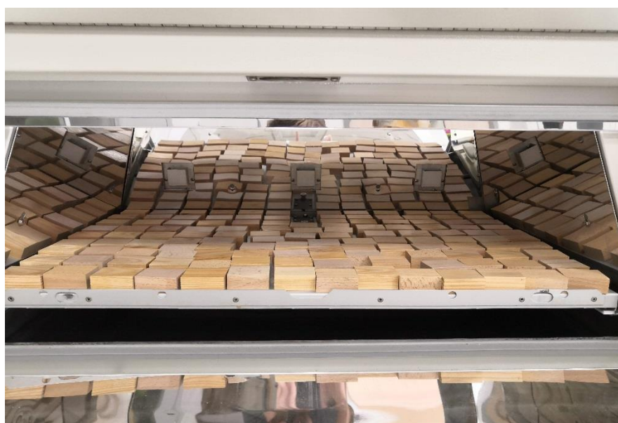
Obrázek 12 Uložení vzorků v Q-SUN
