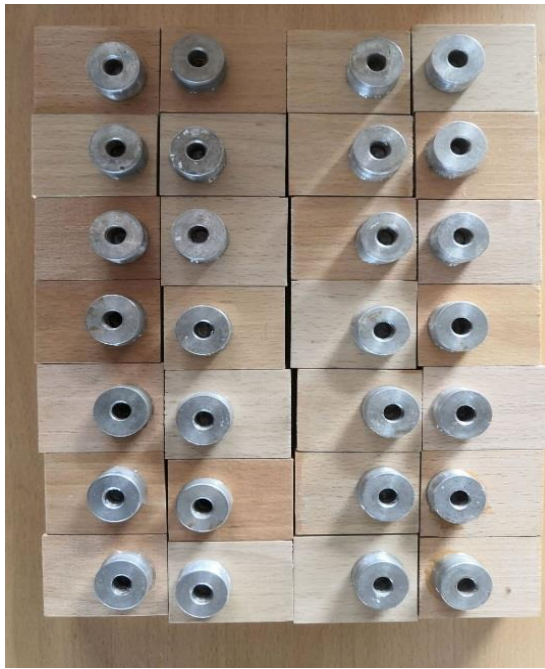
Obrázek 18 Přilepené panenky na tělískách
