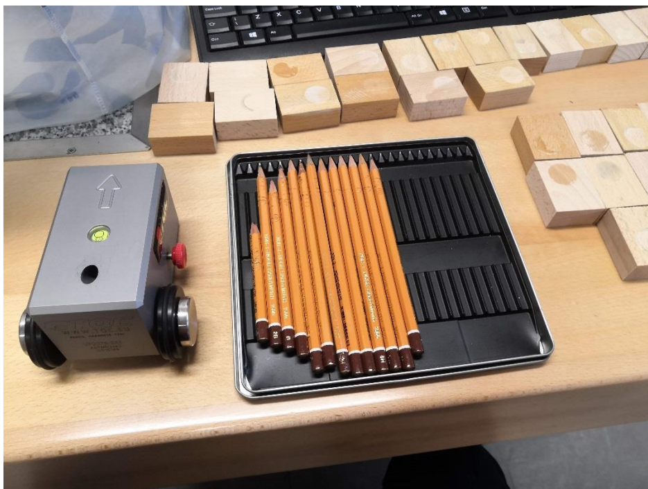
Obrázek 15 Destruktivní metoda dle Wolff-Wilbornova testu (tužkami)
