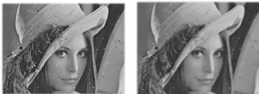
obr. 4.2: Filtrace standardním průměrováním.
