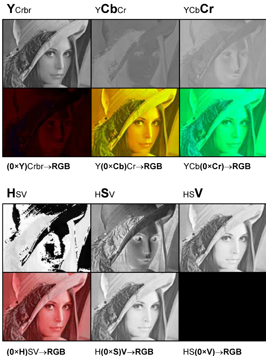
obr. 4.8: Převod z modelu RGB do modelů YCbCr a HSV. Horní řada vždy představuje jednotlivé složky modelu v monochromatickém rozlišení; dolní řada představuje postupně každou složku maximálně potlačenou a pro lepší představu je výsledek převeden zpět do modelu RGB.
