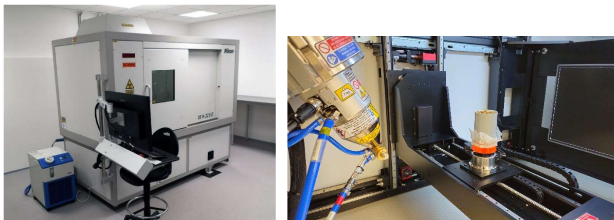
Obrázek 8: CT skener Nikon XT H 225ST v laboratoři katedry pedologie a ochrany půd na ČZU (zdroj: https://katedry.czu.cz/kpop/pristrojove-vybaveni-katedry/tomograf-nikon-xt-h-225st ).
