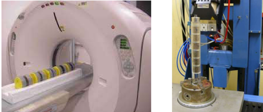
Obrázek 1: Půdní vzorky v medicínském rentgenovém tomografu (Toshiba Aquilion CX) (vlevo) a v mikrotomografu (vpravo) (Kuka et al. 2013).
