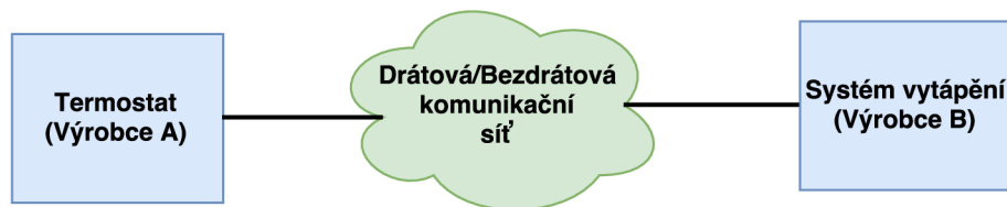
Obr. 2.4: Znázornění komunikačního modelu Device-to-Device.
