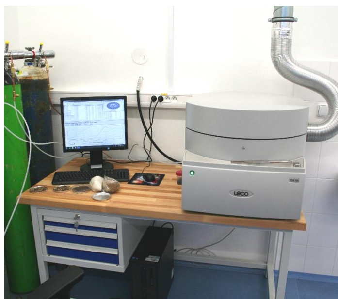
Obrázek 12: Analyzátor LECO TGA (termogravimetrický analyzátor)
