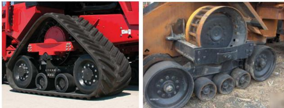
Obr. 13 Podvozek delta traktoru Versatile (nalevo). Pevné uchycení modulu podvozku na traktor CASE IH Quadtrack STX 450 (napravo) [10, 14]
