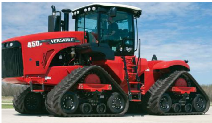
Obr. 14 Traktor Versatile se čtyřmi pásovými jednotky delta a kloubovým řízením [14]
