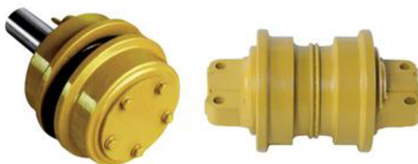
Obr. 9 Podpěrná kladka – vlevo, Pojezdová kladka – vpravo [37]
