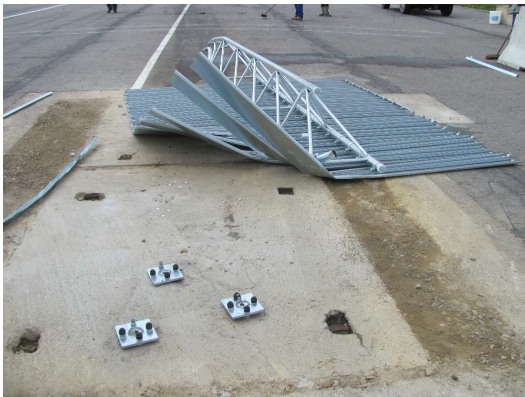
Obr. 5: Výsledek crash testu funkčních vlastností, zdroj: [20]
