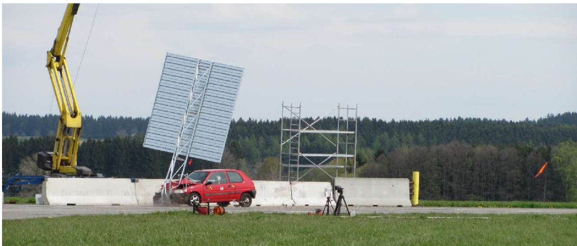
Obr. 4: Crash test funkčních vlastností, zdroj: [20]
