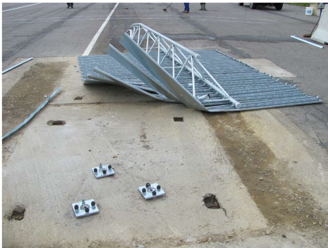
Obr. 5: Výsledek crash testu funkčních vlastností, zdroj: [20]
