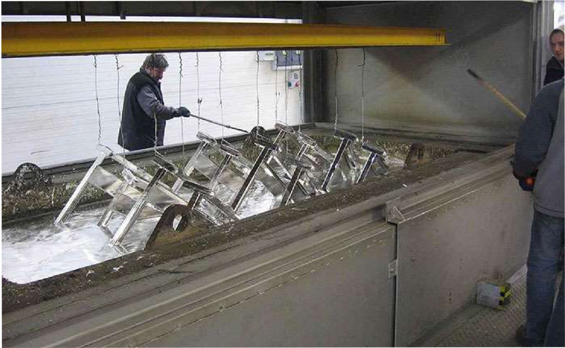
Obr. 2: Žárové zinkování, zdroj: [24]
