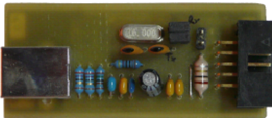
Obr. 32 Modul pro sériovou komunikaci mezi PC a mikrokontrolérem s USB rozhraním
