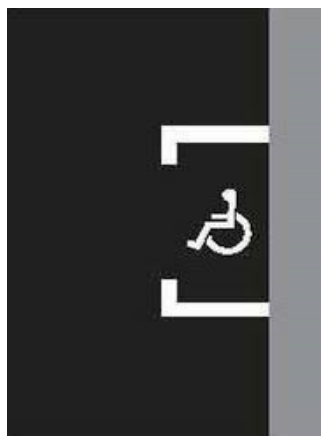
Obrázek č. 3: vodorovné dopravní značení V 10f [14].
