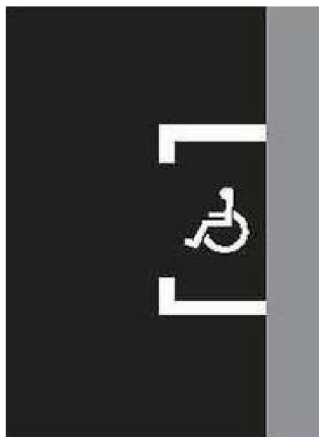
Obrázek č. 3: vodorovné dopravní značení V 10f [14].
