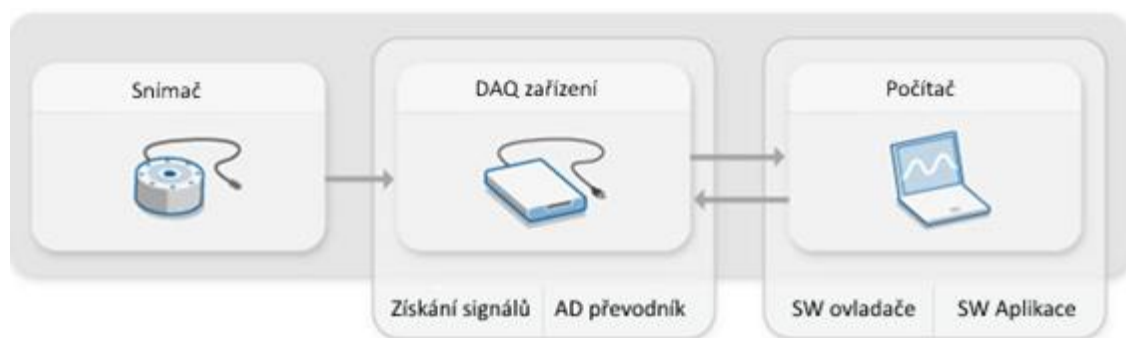
Obrázek 29. Propojení snímačů s počítačem pomocí DAQ zařízení[11].
