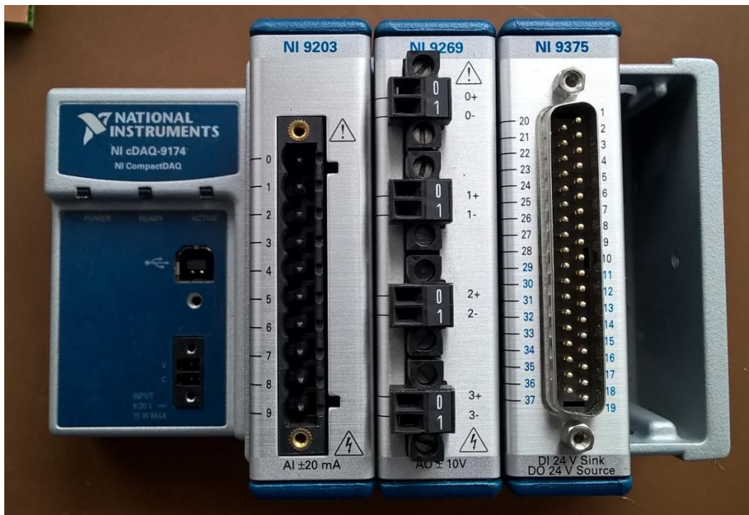
Obrázek 30. Kompletní modulární sestava DAQ zařízení
