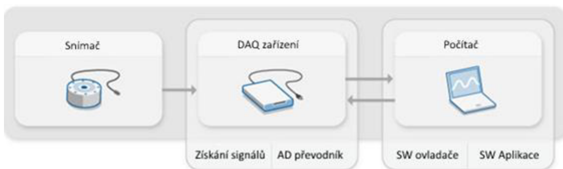
Obrázek 29. Propojení snímačů s počítačem pomocí DAQ zařízení[11].
