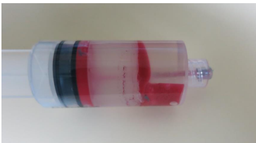
Obr. č. 31: Stříkačkové zařízení z PDMS po reakci s Čugajevovým činidlem
