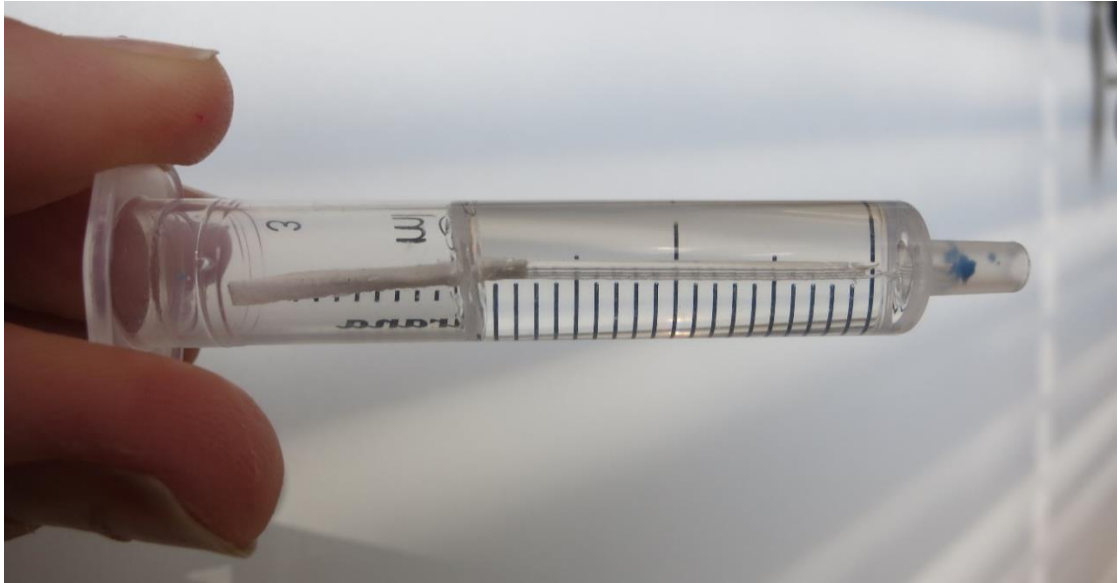
Obr. č. 24: Kanálek s indikačním celulóзовým papírkem
