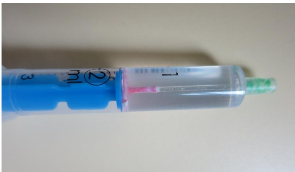
Obr. č. 26 Důkaz nikelnatých iontů pomocí Čugajeva činidla
