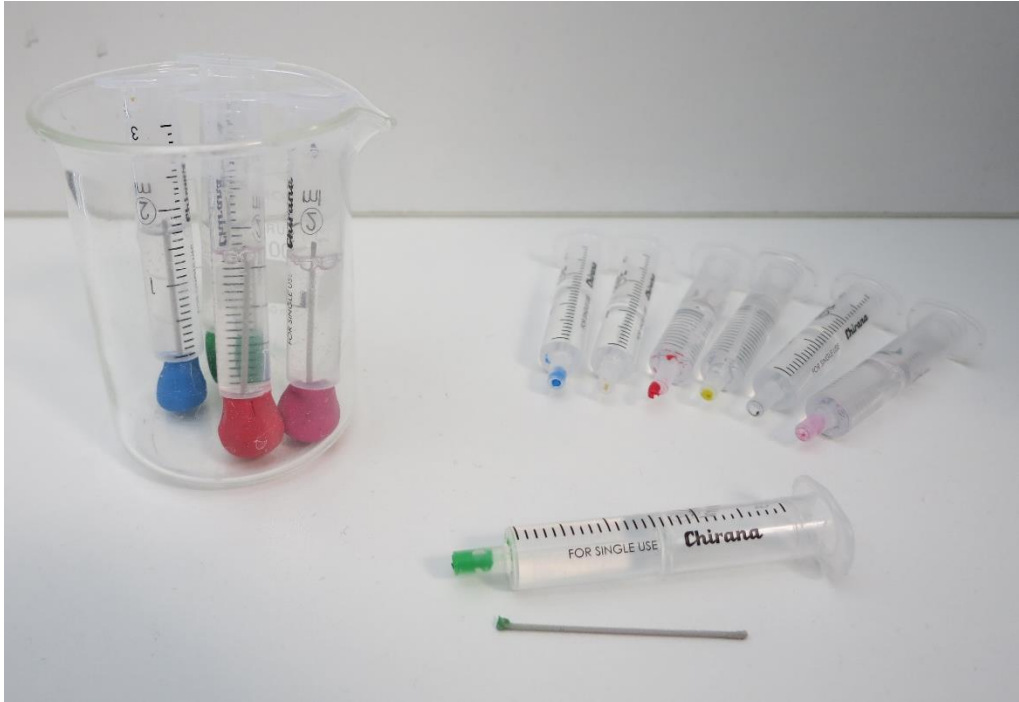
Obr. č. 18: Zalité kanálky v injekčních stříkačkách upevněné modelovací hmotou (vlevo) a vytvrzené kanálky po odstranění vytištěných tyčinek (vpravo)
