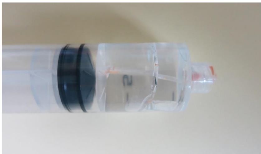
Obr. č. 30: Stříkačkové zařízení po vytvrzení PDMS
