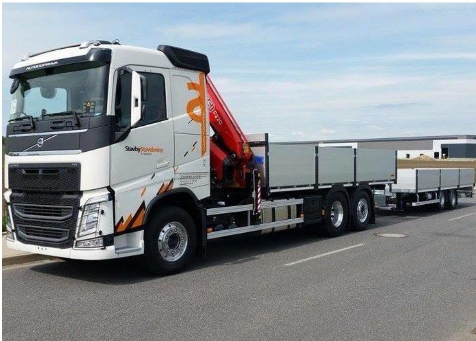
Obrázek 44 Valníkový automobil Volvo FH s hydraulickou rukou fassi 545 [8]
