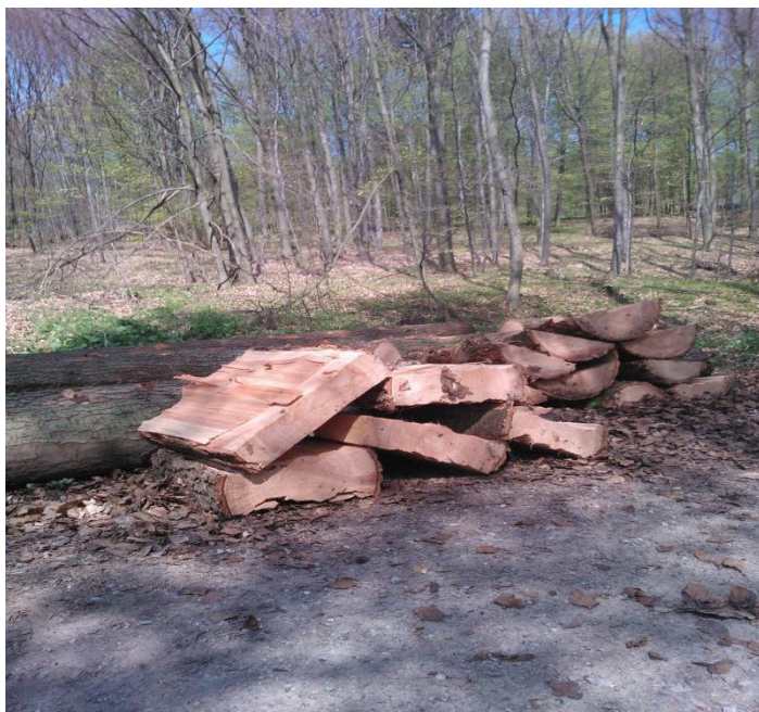
Obr. 5 Vyštipané středové prizmy za účelem odebrání materiálu na zkušební vzorky (Lokalita 3, 135C 9, SLT 3A)
