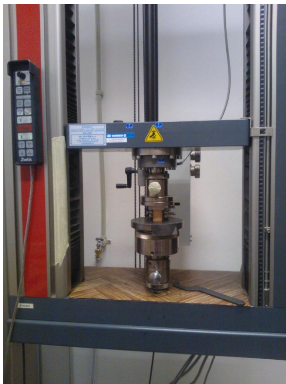
Obr. 18 Zkušební tlakové tělísko mezi deskami univerzálního zkušebního stroje Zwick Z 050
