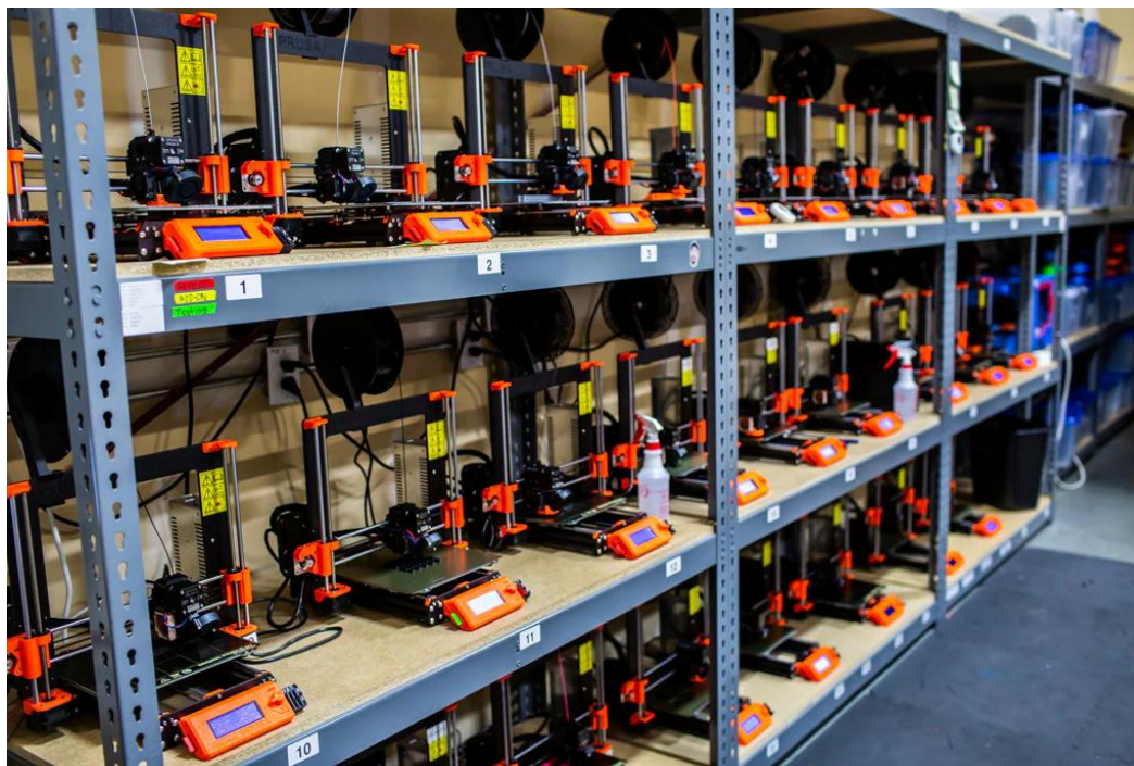
Obrázek 6 příklad farmy 3D tiskáren (Goodman, January 30 2020)
