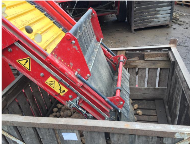
Obrázek č. 24: Automatické nakládění plniče
