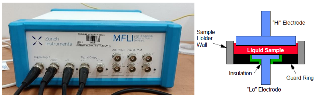
Obrázek 3.1: Přístroj MFLI od firmy Zurich Instruments používaný pro EIS (vlevo) a schéma komory pro tekuté vzorky (vpravo).
