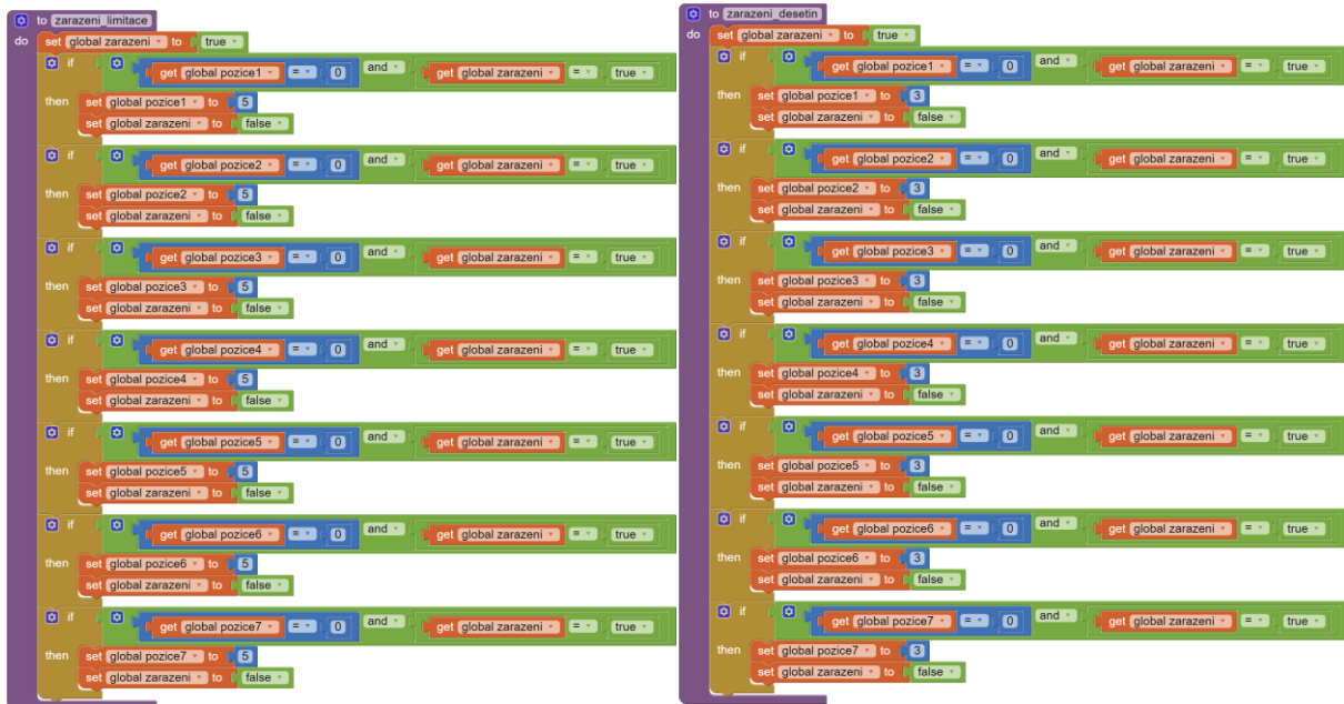
Obrázek 20: Bloky řadičí datové rámce do fronty vysílače v mobilní aplikaci
