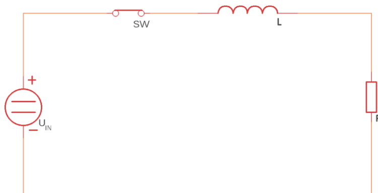
Obrázek 3: Sepnutý RL obvod
