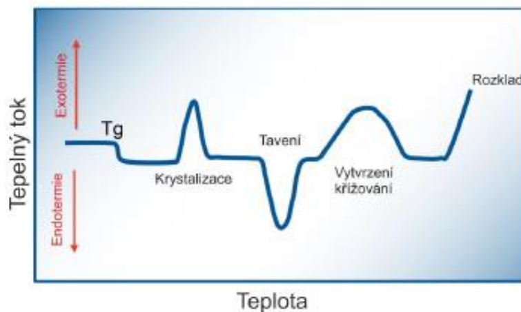
Obr. 6: Chemická reakce při diferenční kompenzační kalorimetrii [1]
