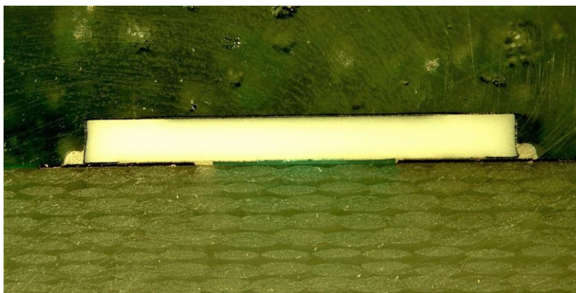
Obr. 43: Mikrovýbrus, rezistor bez zatížení
