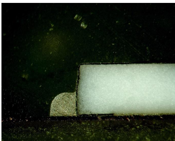
Obr. 41: Detail mikrovýbrusu, zatížení rezistoru 168 hodin
