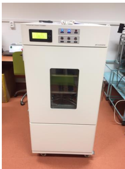
Obr. 33: Klimatická komora SDH01
