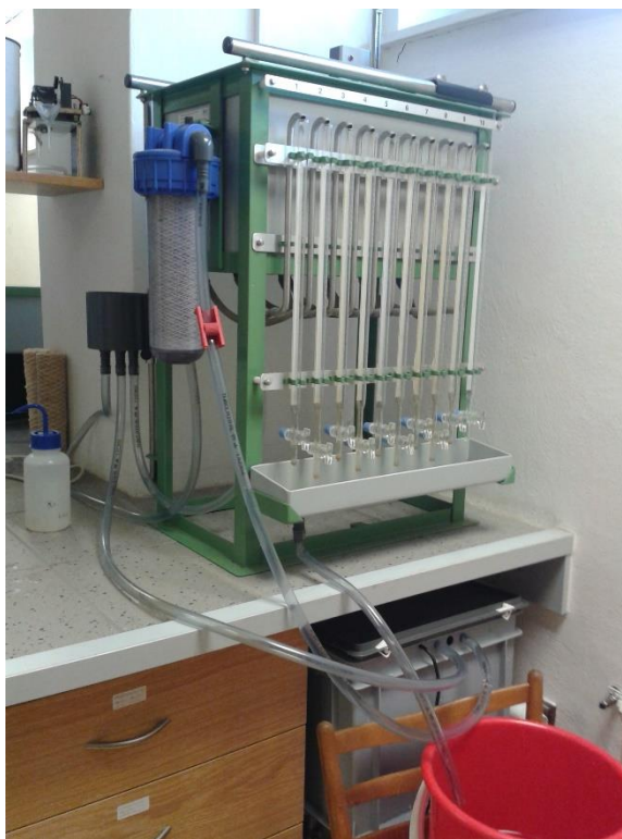
Obr. 19 – laboratorní permeametr od firmy Eijkelkamp
