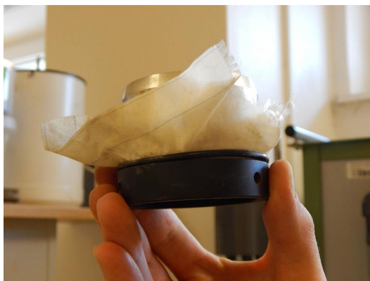
Obr. 17 – Připevněná gáza gumičkou
