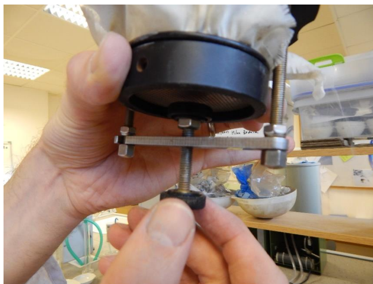
Obr. 18 – Pevně připevněný vzorek v držáku
