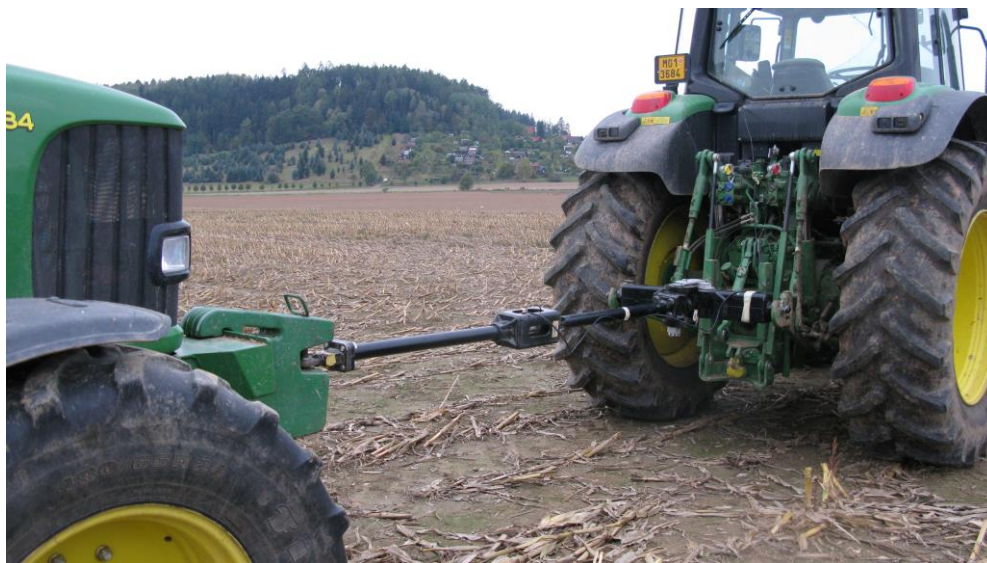
Obrázek 3: Souprava pro měření tahového odporu v roce 2016
