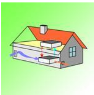
Obr. 7: TČ odpadní vzduch/voda. (Zdroj: http://hestia.energetika.cz/encyklopedie/6.htm )
